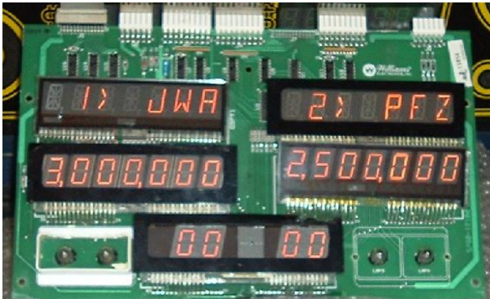
D-11610: De "F-14" à "Swords of Fury", voici la carte tout en un, équipée de 2 afficheurs alphanumériques 7 caractères et 2 afficheurs numériques 7 chiffres. L'afficheur pour les crédits/nombre de bille n'est plus utilisé.
