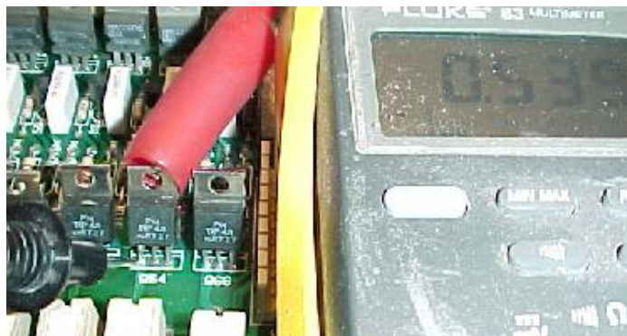
Test d'un TIP42 commandant une colonne de l'éclairage matriciel sur CM/CD.
