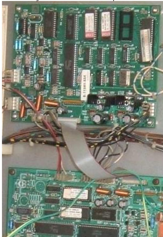
CS D-11581 sur System11B, avec emplacements U6/U7/U18 vides. Cette carte a les cavaliers W2/W3 déposés et utilise des EPROMs 27256. Cette carte provient d'un "Earthshaker".
