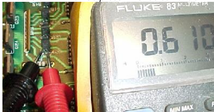
Test d'un 2N4401 de précommande sur CM/CD.
