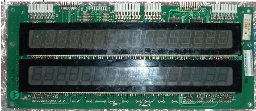
D-12232: A partir de "Taxi", voici la carte d'affichage équipée de 2 afficheurs alphanumériques de 16 caractères.
