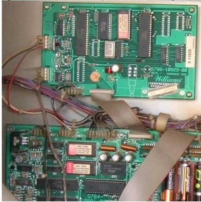
CS D-11581 System11A. Cette carte provient d'un F-14.
